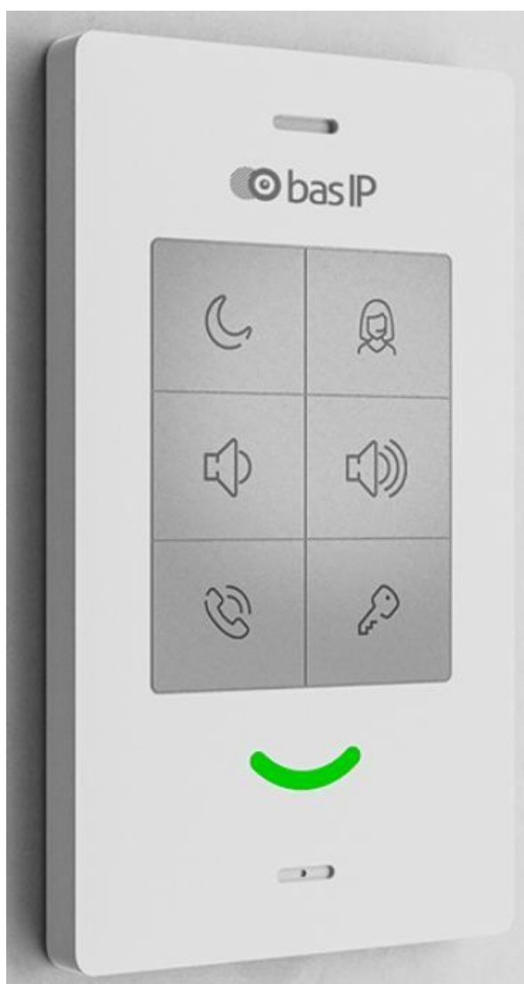
Рис. 6 Внешний вид абонентского устройства SP-03F.
