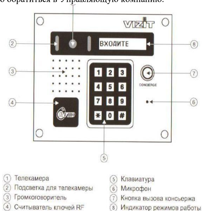
Рис. 5. Внешний вид и органы управления блока.
