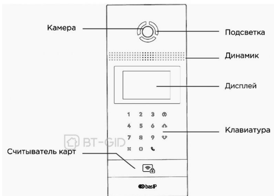
Рис. 5. Внешний вид и органы управления блока. Рисунок может отличаться от фактического вида устройства.
