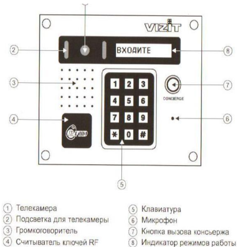
Рис. 5. Внешний вид и органы управления блока.
