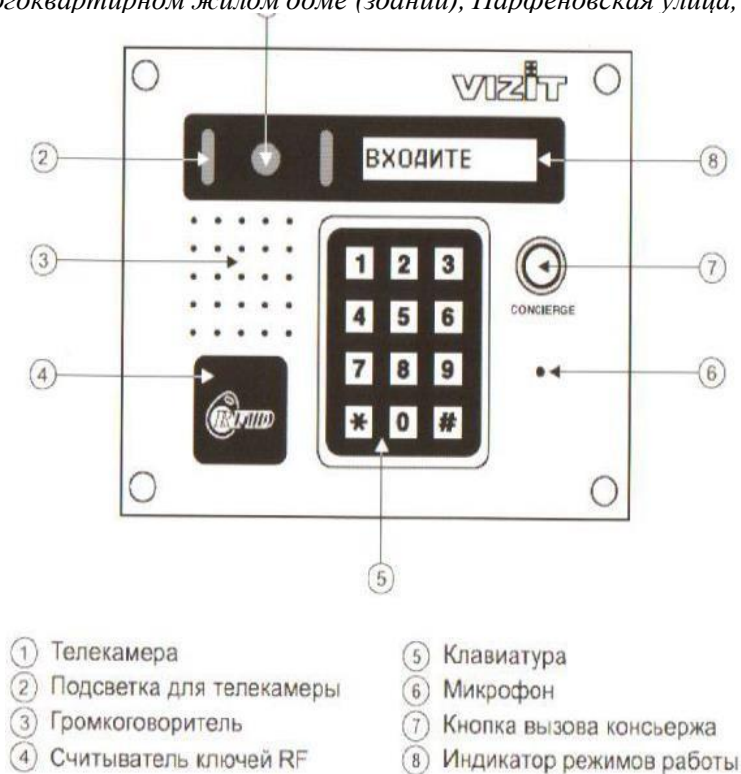
Рис. 5. Внешний вид и органы управления блока «VIZIT».
