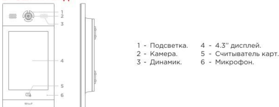
Рис. 5. Внешний вид и органы управления блока «BASE IP».
